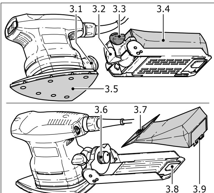
Les machines sont équipées en série d'un dispositif d'auto-aspiration. La poussière de ponçage est aspirée à travers les orifices d'aspiration du patin de ponçage (3.5) puis collectée dans le filtre turbo (3.4). Lorsque le filtre turbo est rempli de poussières, la performance d'aspiration baisse et il faut le remplacer.
